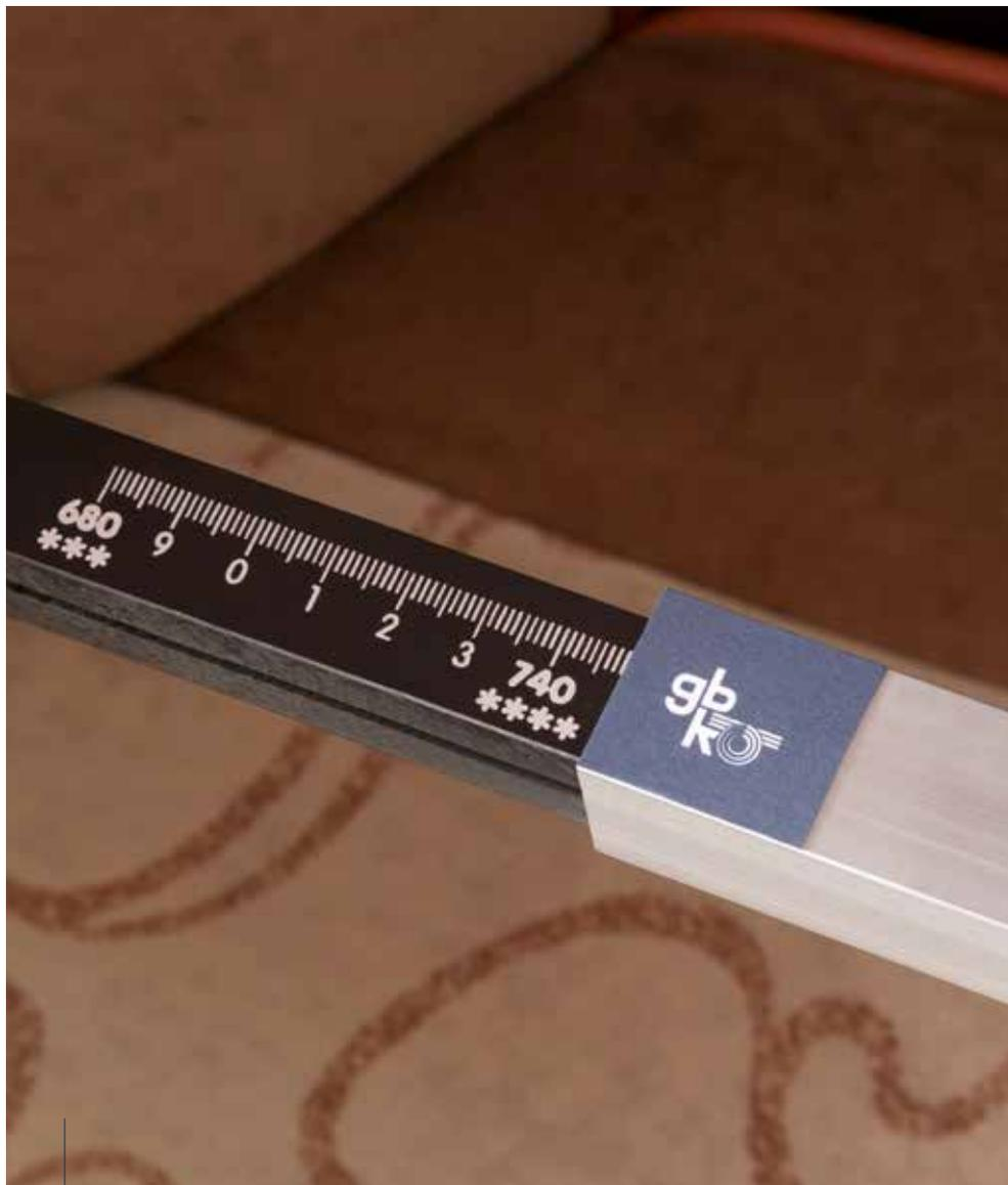
Die Skala auf dem Messgerät zeigt dem Sachverständigen vom TÜV Süd an, dass der Reisegast in diesem Bus der Firma Pflieger in Böblingen auf der waagerechten Höhe von 62 Zentimetern eine Beinfreiheit von mindestens 74 Zentimetern genießt und damit eines der zentralen Kriterien für den Qualitätsstandard im Vier-Sterne-Bus erfüllt wird.
