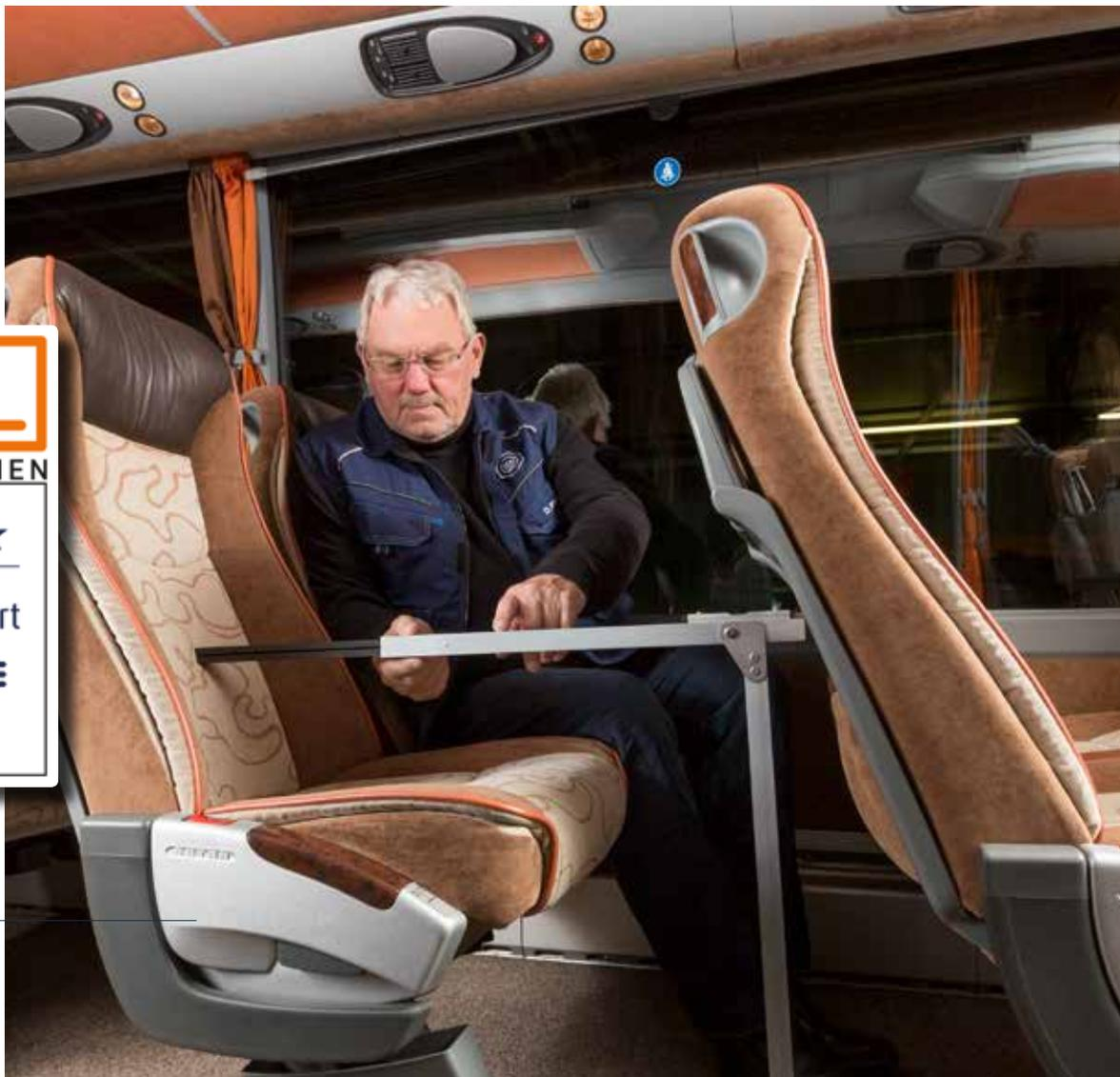
Mit einem speziellen Messgerät kontrolliert der TÜV Süd-Prüfingenieur Dieter Schmidt die Beinfreiheit im Vier-Sterne-Bus.
