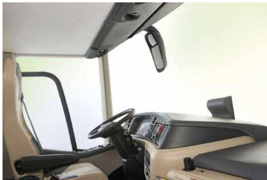
Die Ingenieure von VDL haben den Boden an der Frontscheibe des Futura FDD2 schräg aufwärts verlaufen lassen und so den Blickwinkel des Chauffeurs deutlich erweitert. *Bilder: VDL*
