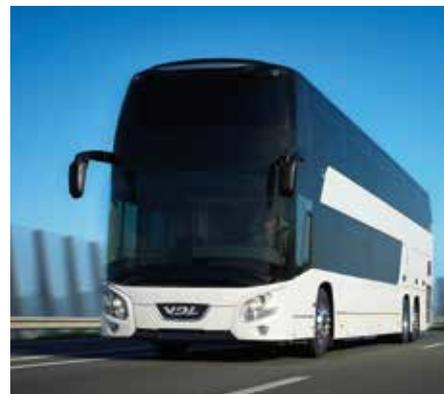
Der Blick des Chauffeurs wird nach oben gelenkt. Die Ingenieure von VDL haben nämlich den Boden an der Frontscheibe schräg aufwärts verlaufen lassen und so den Blickwinkel deutlich erweitert. Dies kommt auch größeren Fahrern zugute, vor allem vor hoch angebrachten Ampeln und Verkehrsschildern. Hinzu kommt, dass dadurch die Außenspiegel höher positioniert werden konnten. Sie befinden sich jetzt in zwei Metern Höhe.
